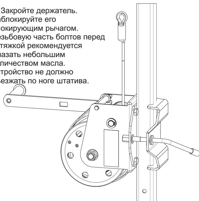
4. Проведите трос сзади двух болтов размещенных над барабаном для намотки.
